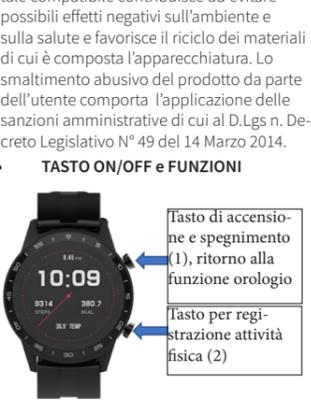
Tenendo premuto a lungo il tasto laterale (1), si accende e si spegne l'orologio; inoltre, da qualsiasi schermo, premendolo brevemente, si torna alla funzione orologio.
